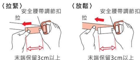
● 輕押安全腰帶調節扣，拉安全腰帶做調整。
