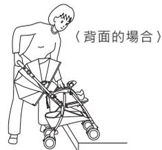
背面的場合使用下，將手把向下輕壓，同時抬起安全扶手，讓手推車越過段差處。
