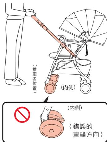
推車者位置的左右車輪朝內鎖上時，請解除前後左右的手動迴轉固定器之後，再進行操作手把切換的動作。正確的車輪方向請參閱P15。
